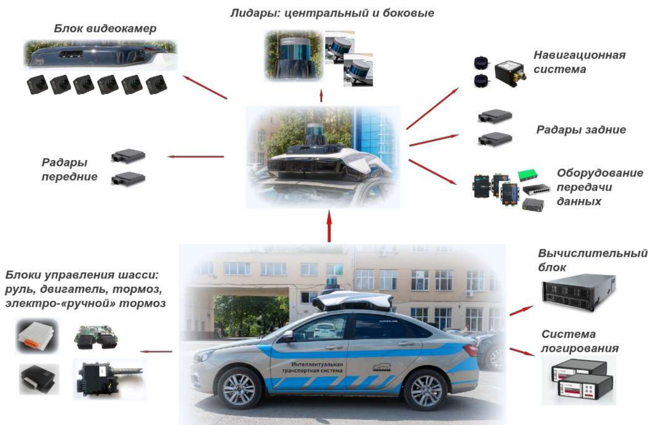
Рисунок 4 – Беспилотный автомобиль Lada Vesta с установленной системой автономного управления движением
